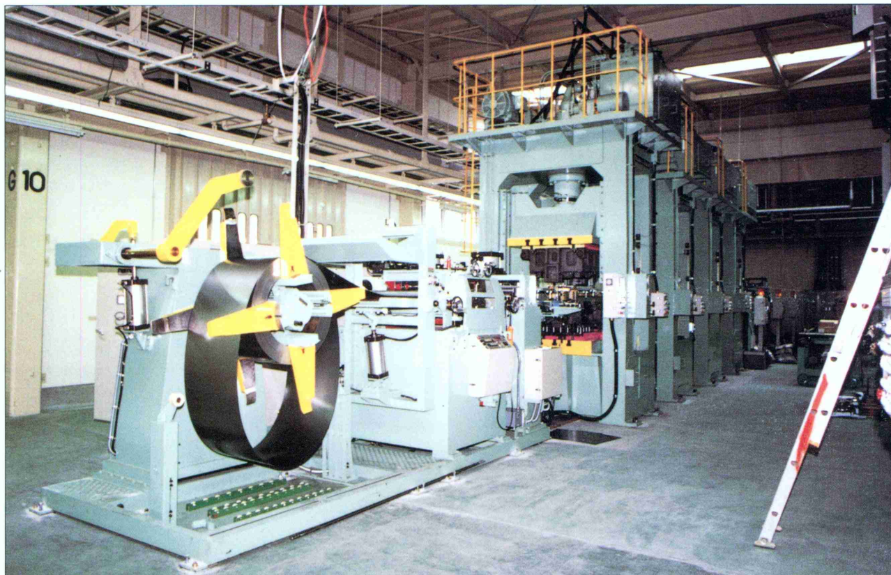
写一36 4連装タンデム油圧プレスライン
